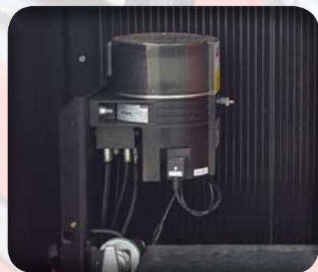
Impianto di ingrassaggio centralizzato automatico di serie per ralla, bracci e martinetti.
