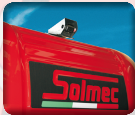
Telecamera posteriore (a richiesta) con display a colori da 7" in cabina. (Possibilità di installazione anche su braccio secondario)
