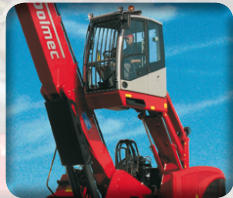
Elevazione idraulica a parallelogramma di serie con altezza occhio operatore 5,2 m. Su richiesta si può arrivare ad altezza 6,0 m.
