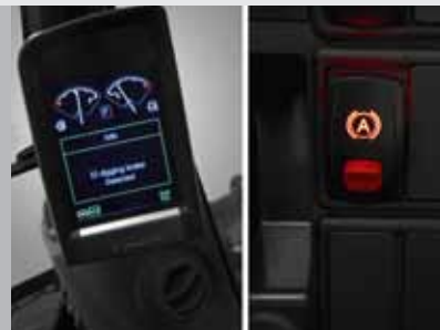
Frein de creusement automatique
