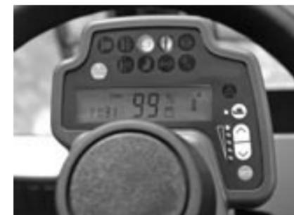
Cinq pré-programmations permettent d'adapter les performances du chariot aux différentes applications du marché. Le tableau de bord convivial inclut un autodiagnostic, un témoin de décharge batterie ainsi que des affichages d'avertissement, de code d'erreur, de désactivation du levage et une horloge.
