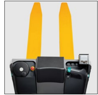
Bedienelemente und Zusatzdisplay in Lastrichtung (optional)
