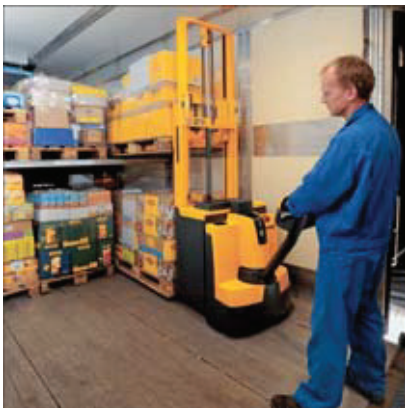
Doppelstockbeladung eines Lkw
