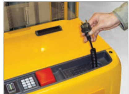
Integriertes Ladegerät (24 V/30 A) für das bequeme Aufladen der Batterie an jeder Netzsteckdose
