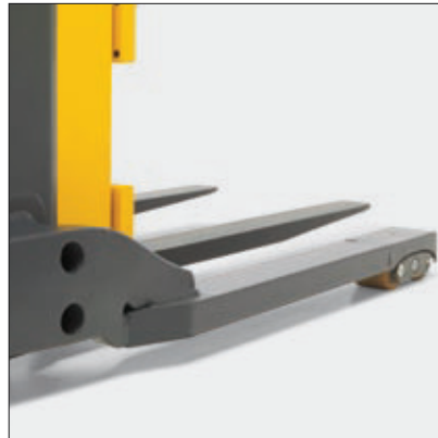
Radarm mit patentierter Tandemlastradwippe
