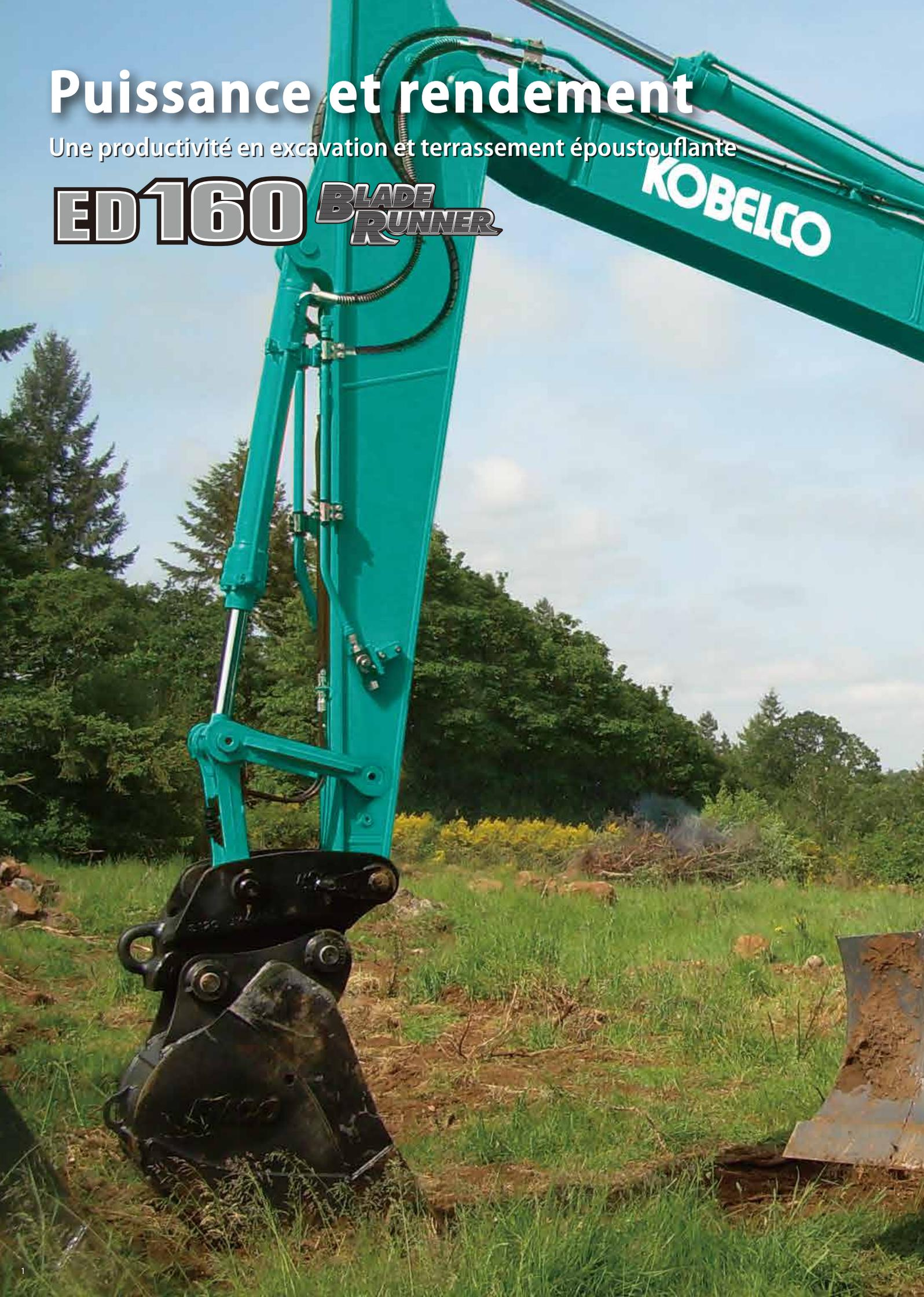
Équipez une pelle hydraulique à rayon court de 15 tonnes d'un châssis de bull dozer et d'une lame repliable de terrassement 6 voies, et vous obtenez la ED160 Blade Runner. Une seule machine pour une diversité d'applications inégalée, particulièrement efficace en travaux de nivellement, d'excavation, de pose de canalisations et de remblai, et vous offrant une augmentation spectaculaire de votre productivité.
