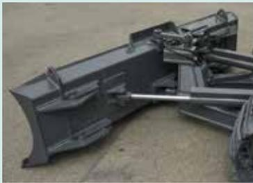
La Lame PAT 6 voies est entièrement pilotable hydrauliquement depuis son manipulateur dédié. Elle est inclinable à 25 degrés vers la gauche ou vers la droite pour évacuer la terre et les matériaux de la trajectoire de la machine. Elle est basculable de 455 mm à droite ou à gauche pour le nivelage de pente et talus, ou la réalisation de fossé.
