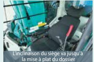
L'inclinaison du siège va jusqu'à la mise à plat du dossier
