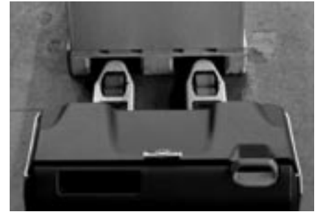
Formes de l'appareil optimisées pour une bonne visibilité des pointes de la fourche
