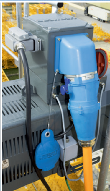
Elektrische Steckverbindung des Hubwerks.
