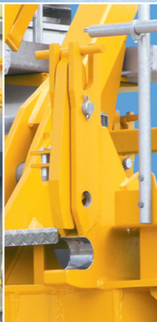
Schnellverbindung für Ausleger und Gegenausleger.
