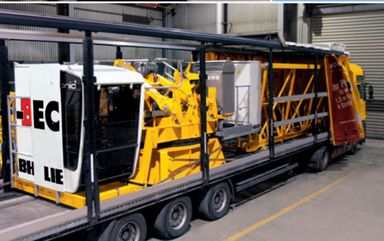
Stehender Transport des Kompaktkopfes im LKW.
