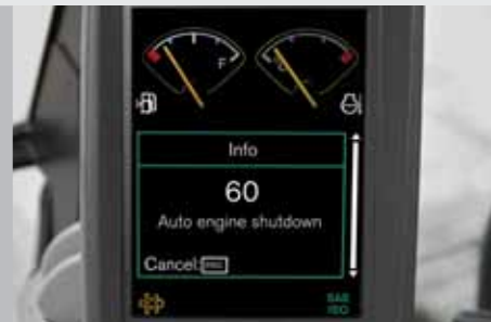
Parada automática del motor
