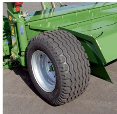
Nejlépe vybaven: Zvlněný terén a kopcovitá krajina kladou na stroje vysoké nároky. Pneumatiky 15.0/55-17/10 běží velice lehce a jsou šetrné ke strništi. Kola nastavená se sbíhavostí 3° eliminují boční tahy a udržují přímý směr jízdy.
