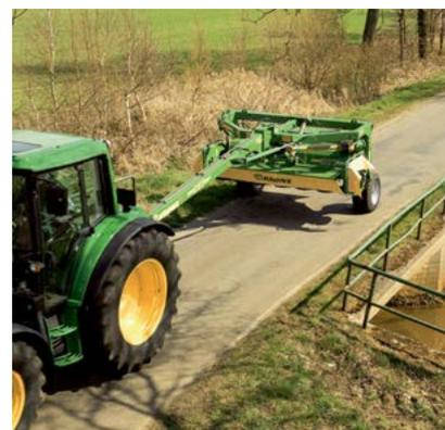
Rychlostí 40 km/h z jednoho místa na druhé: Tažené žací mačkače EasyCut 3210 CV a CRi díky středovému zavěšení nepřesahují při přepravě šířku 3,00 m, a proto nepotřebují pro provoz na pozemních komunikacích žádné zvláštní povolení.
