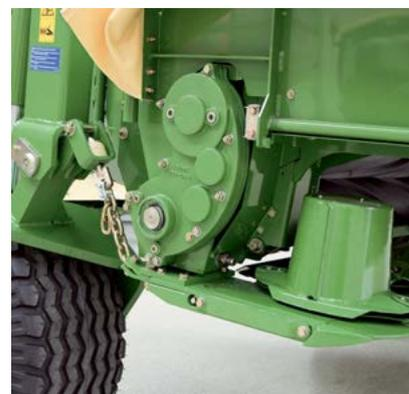
Sériově dvojitý pohon: Horní válec je také aktivně poháněn. Doplňkový pohon od spodního válce je synchronizován pomocí převodovky umístěné na levé vnější straně žací lišty.
