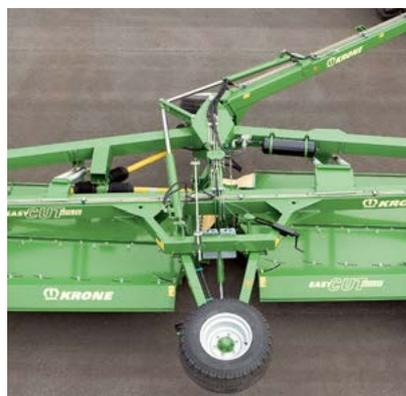
Nastavení výšky strniště – pohodlné a rychlé: pomocí závitového vřetena můžete plynule nastavit výšku strniště jednotlivých žacích jednotek.
