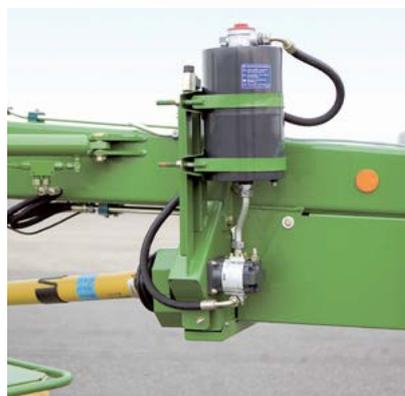
Palubní hydraulika: Pohon příčného dopravníku je zásobován z vlastní olejové nádrže samostatným hydraulickým okruhem. Proto je tento stroj nezávislý na hydraulice traktoru. Hydraulika traktoru je tak odlehčena a méně zatížena.
