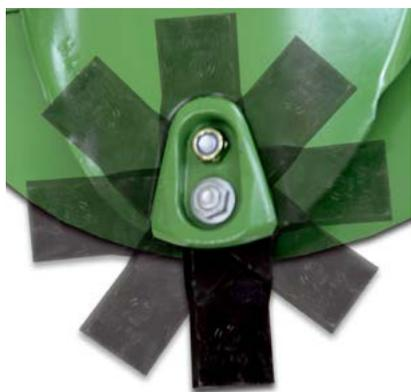
Otočné o 360°: nože se mohou volně otáčet kolem upevňovacího čepu. Jsou dobře chráněné, nemohou se vzpříčit, mají vysokou životnost a samočisticí schopnost.
