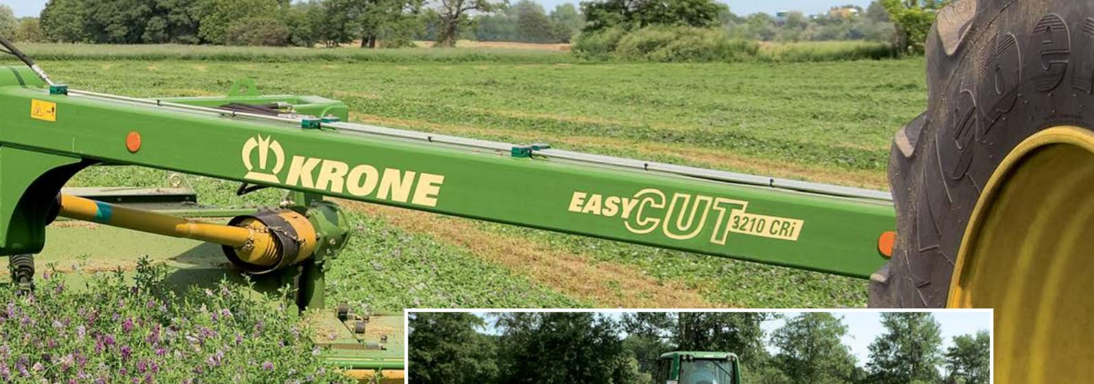
Tažené diskové žací stroje EasyCut 3210 CV nebo CRi a 4013 CV s kondicionéry pracující po celém světě se nejlépe osvědčily jak sólo, tak v kombinaci s čelní lištou. Díky středově umístěné oji můžete postupně kosit z jedné strany pole na druhou v obou směrech.
