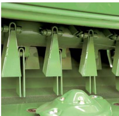
Vše na dopravník: Při použití příčného dopravníku musí ocelové V-prsty kondicionéru píci nejenom dobře zpracovat, ale zajistit také její dopravu. Pro zvýšení dopravní účinnosti je část prstů uzavřena.
