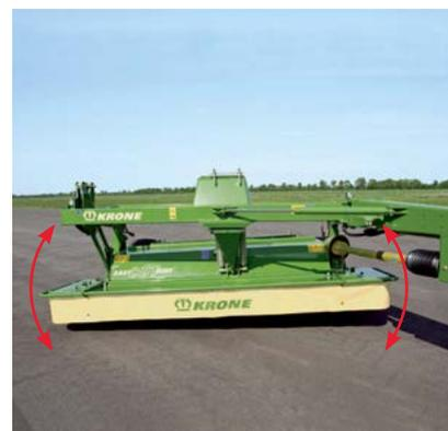
Rychle a jednoduše: Výška strniště se nastavuje vřetenem s klikou. Žací mačkáčské EasyCut 2801 CV a EC 3201 CV lze osadit hydraulickým válcem, který lze objednat jako zvláštní příslušenství. Potom lze pracovní výšku nastavovat pohodlně z místa řidiče, který toto ovládání ocení zejména na členitém a nerovném pozemku.
