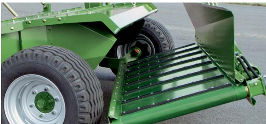
Zde se nic neucpává: rychlé sečení, těžký porost – s šířkou pásu 900 mm se na správné uložení píce můžete spolehnout. Navařené lišty na pásu zajistí kontinuální tok hmoty. Řádky jsou rovnoměrné a bezvadně se hodí pro další sklizňové stroje, které je pak mohou velmi snadno sbírat.
