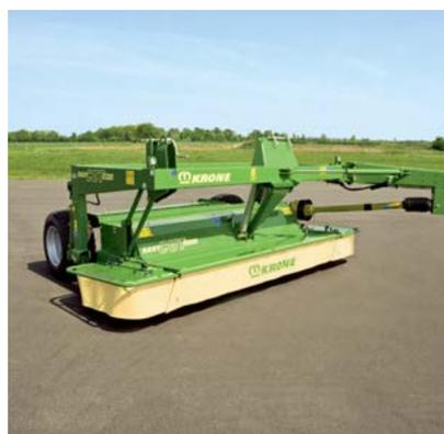
Nižší přítlak – větší přítlak: Tažné pružiny umožňují rychlé a optimální přizpůsobení pracovním podmínkám. Větší rozsah nastavení a snadné ovládání vás přesvědčí.
