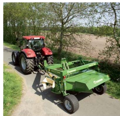
Jde to samo: Z kabiny traktoru přestavíte hydraulicky žací stroj z pracovní polohy do přepravní. Abyste mohli využít celý pracovní záběr žacího stroje agregovaného traktory s různými rozchody kol, lze hydraulický válec pro natáčení stroje plynule přestavit do několika pozic.
