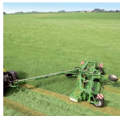
EasyCut 2800 CRi, 3200 CRi a 3210 CRi s mačkacími válci: tyto válce překrývají celý pracovní záběr stroje. Profilované mačkací válce, zapadající vzájemně do sebe, jsou především předurčeny pro úpravu vojtěšek, jetelů a ostatních listových plodin.
