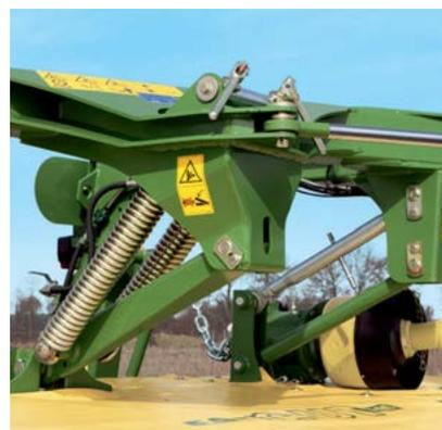
Praktický: Rám žacího stroje EasyCut 3200 se stranovou ojí je robustní a kompaktní. Světlá výška rámu umožňuje velký výkyv žacího nosníku, který je zavěšený v těžišti a stranově vedený paralelogramem. S touto konstrukcí zvládá EasyCut 3200 čistou a bezztrátovou sklizeň i na nerovných pozemcích. Pohon žací lišty zajišťuje přímo od traktoru kardanový hřídel připojený na úhlovou převodovku. Ta je integrovaná v žacím nosníku za vnějším bubnem.
