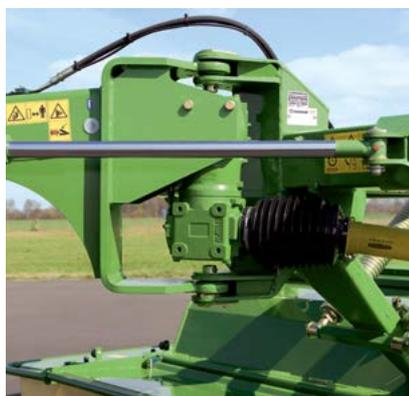
Pohon bez klínových řemenů: Pohon žací lišty a kondicionéru je realizovaný prostřednictvím převodovky a kloubových hřídelí. Dvě otočné převodovky optimalizují klidný chod stroje. Bezpečnost tohoto pohonu zajišťuje pojistná spojka.
