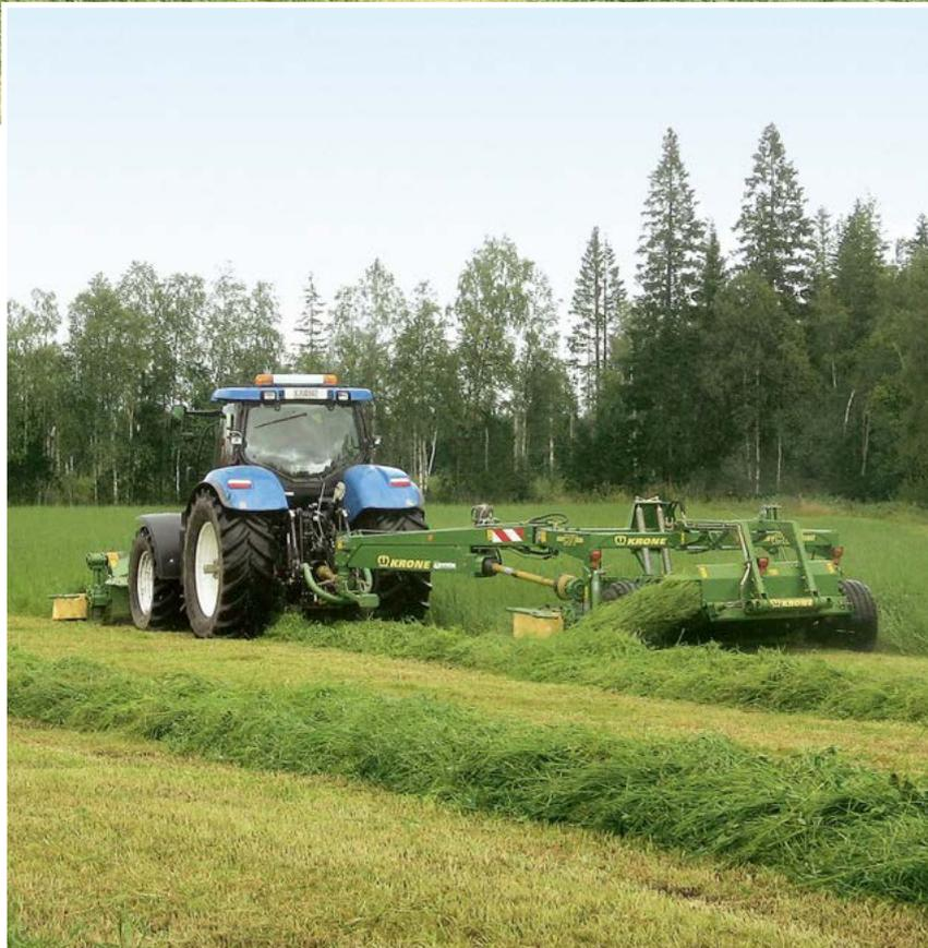
V kombinaci s čelními žacími stroji KRONE EasyCut 32 CV a 32 CRi se vytvoří při jednom průjezdu složený řádek. Shazovací dopravník uloží píci na řádek nebo vedle vytvořeného čelní žací lišty. S touto kombinací zvýšíte nejen výkon, ale ušetříte čas i peníze úsporou dalších pracovních kroků, jako je obracení a shrnování. To jsou fakta, která vypovídají o přednostech skládání píce z více průjezdů a potvrzují správnost rozhodnutí o nákupu žacího stroje se shazovacím dopravníkem.
