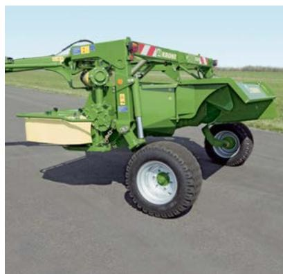
Rychlá manipulace: Žací lišta se při skládání do přepravní polohy hydraulicky nadzvedne a otočí se do středové podélné polohy. Přitom je dosažená velká světlost, ideální pro přejezd hlubokých brázd i širokých posečených rádků píce.
