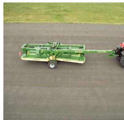
Široký při práci – úzký při přepravě: Otočení stroje z pracovní do přepravní polohy a obráceně zabere pouze několik sekund a bez toho, aniž by řidič musel opustit ka-
