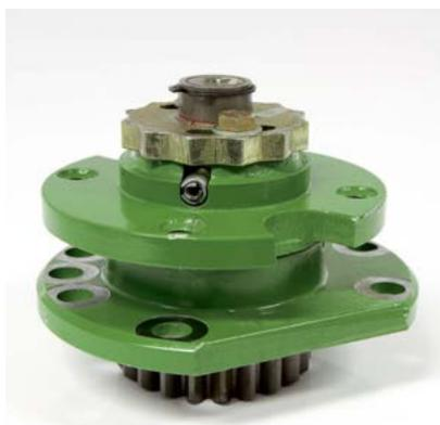
Ideální: Žádné namáhání střížných kolíků při sečení! Žací modul je stažen maticí a dvěma šrouby. Materiálová únava střížných kolíků zde nehrozí. Proto zůstává vypínací moment po celou dobu používání konstantní.
