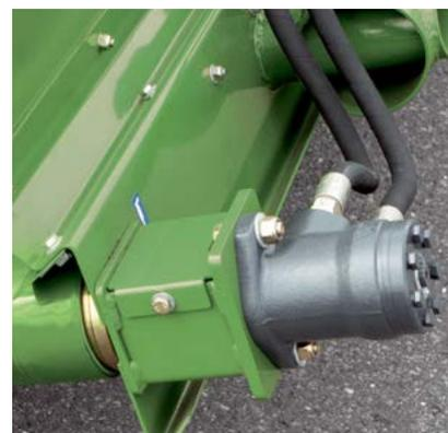
Silný hydromotor s plynule nastavitelnými otáčkami pásu: Díky tomu si můžete upravit šířku řádku podle potřeb sklizňového stroje. Při zvednutí dopravníku se pohon automaticky vypne a při jeho spuštění zase zapne.
