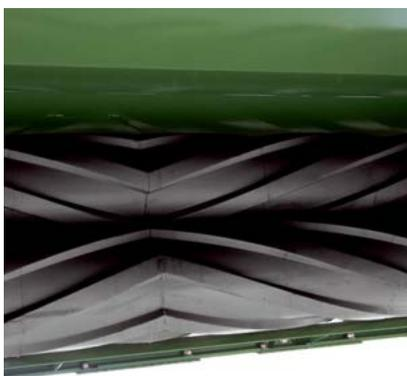
Snadné podávání: Profilované mačkací válce o velkém průměru vzájemně do sebe zapadají. Právě zde mezi profily válců probíhá úprava píce – stonky se mačkají, třou a lámou pro dosažení nejvyšší kvality zpracování.
