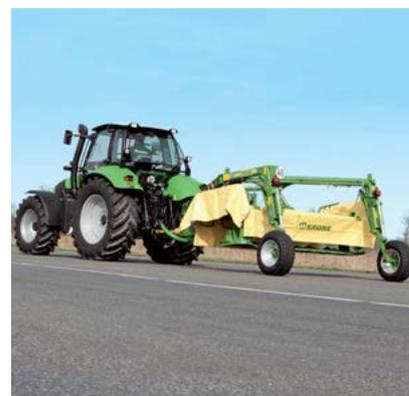
Obratný: Tažená lišta se stranovou ojí a otočnou převodovkou vyseče porost v každém rohu. Dvoubodový závěsný rám lze snadno agregovat do spodních ramen hydrauliky. V některých zemích je předepsané zavěšení do výkynného závěsu.
