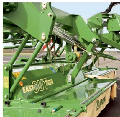
Nejlepší kopírování terénu: Žádná ojedinelá žací lišta o širokém záběru, ale dvě vzájemně přesazené žací jednotky. Pracují nezávisle na sobě a kopírují každou konturu terénu. S diskovým žacím strojem EasyCut 6210 CV získáte tu nejvyšší kvalitu píce.
