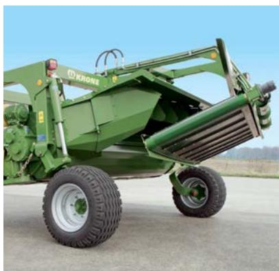
Beze ztrát: V kombinaci s příčným dopravníkem jsou všechny tažené žací stroje EasyCut CV vybaveny ocelovou vanou umístěnou pod rotorovým kondicionérem s ocelovými V-prsty. Tím se dopraví veškerá píce od kondicionéru na dopravník beze ztrát.
