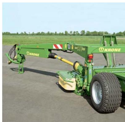
Stabilní otáčky: Velmi stabilní přímý pohon prostřednictvím převodovky a hřídel je velkou výhodou zejména při použití v těžkých podmínkách hustého porostu a při velkých pracovních záběrech. Všechny tažené žací stroje jsou osazeny hlavní převodovkou pro pohon od vývodové hřídele s 1.000 ot/min.
