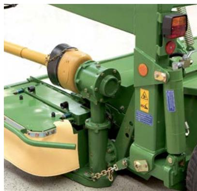
Plný přenos síly: Válce kondicionéru jsou poháněny přímo a bez prokluzů prostřednictvím převodovky. Pohon spodního profilového válce je integrován přímo do pohonu žací lišty za levý žací buben.
