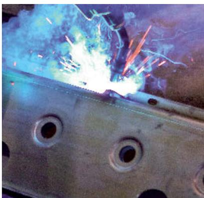
Absolutně těsné a extrémně robustní jsou uzavřené a dokola svařené žací lišty KRONE. Investice do moderních, počítačově řízených svařovacích center a CNC technologií splňují nejvyšší kvalitativní požadavky při výrobě, neboť žací lišty jsou srdcem žacích strojů.
