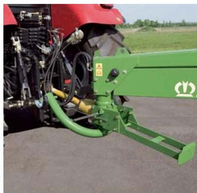
Otočná převodovka: Žádné natáčení kloubů hlavního kardanového hřídele při zatáčení. Zvyšuje to jeho životnost. Dále otočná převodovka díky přenosu kroutícího momentu působí proti bočnímu zavěšení oje a zajišťuje tak dobré vedení stroje.
