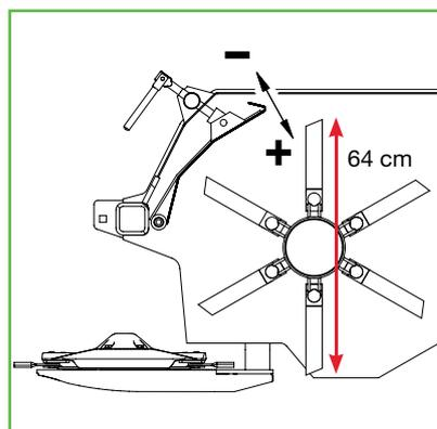
Dva v jednom: pohon žací jednotky i kondicionéru je řešen prostřednictvím společné převodovky. Integrovaná řaditelná převodovka pro pohon kondicionéru CV umožňuje upravit jeho otáčky ve dvou stupních: 600 a 900 ot/min.
