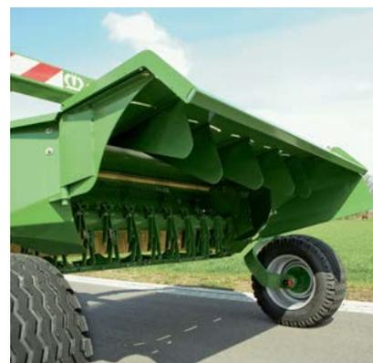
Plný záběr: Kondicionér svými ocelovými V-prsty a rýhovanou clonou překrývá celý pracovní záběr stroje od levého až k pravému krajnímu žacímu bubnu. Vytváří rovnoměrný proud sklizené píce v celém záběru stroje a umožňuje její optimální rozložení. Doplňkové tvarové clony pomáhají rozložit píci na široko a urychlit tak proces prosychání.
