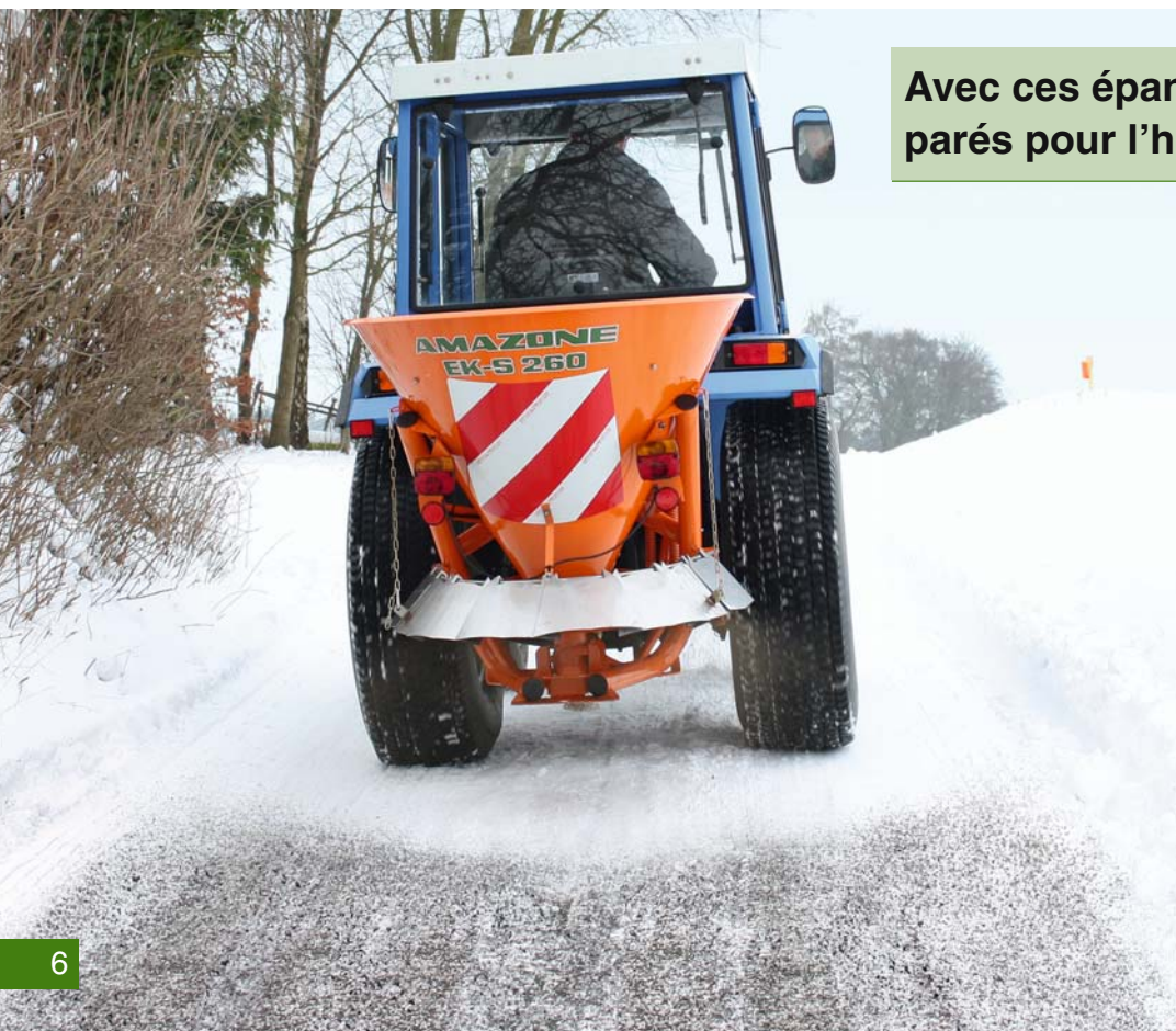
L'EK-S 260 avec train de roulement et éclairage (en option également avec l'homologation routière).
