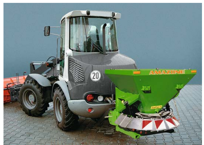
E+SH : L'entraînement hydraulique permet par ex. l'adaptation sur un chargeur à roues.
