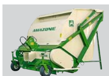
Tondobalai avec bennage en hauteur de la trémie
