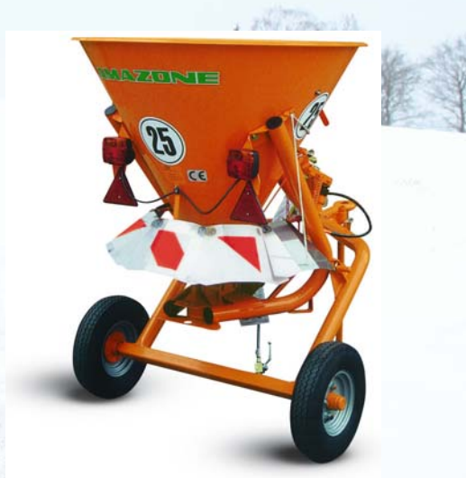
L'EK-S 260 avec train de roulement et éclairage (en option également avec l'homologation routière).
