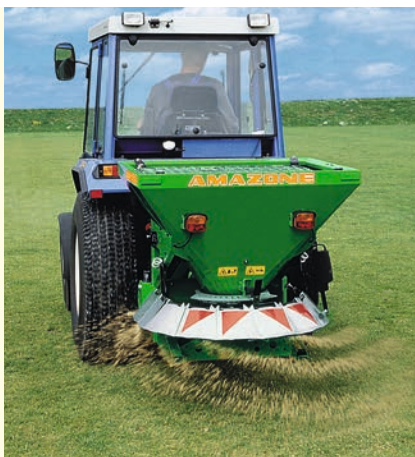
Aplicación de arena
