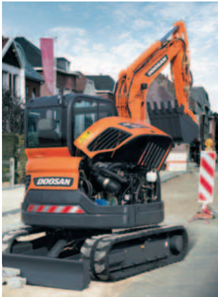
Maintenance aisée : accessibilité latérale aux différents composants du moteur
