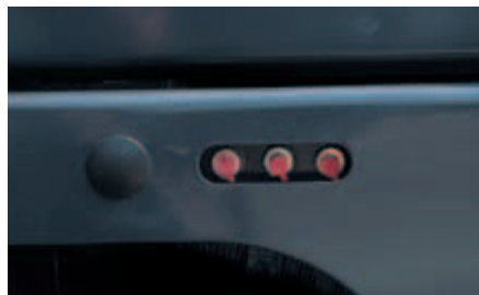
Graissage : intégré pour faciliter la maintenance du déport de pied de flèche et du vérin
