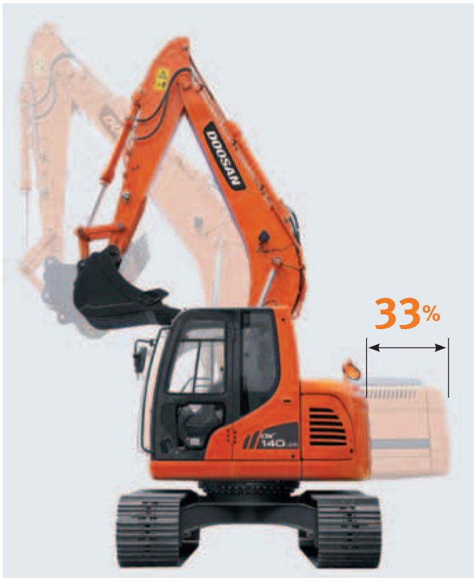
Das Heck steht lediglich 15,5 bis 23,5 cm über dem Unterwagen hervor
