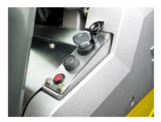
La versión de arrancador eléctrico puede arrancarse fácilmente con la llave de contacto. Un fuerte indicador acústico le avisa antes de que la batería se vacíe por completo.
