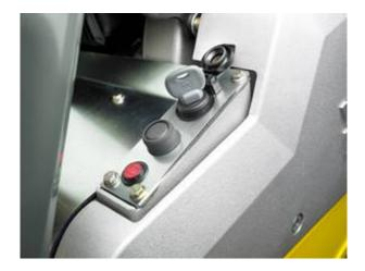
Версия с электростартером удобно заводится с помощью ключа зажигания. Сигнальное устройство выключения зажигания с громким сигналом помогает избежать ненужной разрядки аккумуляторной батареи.
