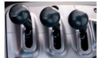
Control preciso 3 palancas controlan el brazo de elevación, el cucharón y el tercer circuito. El interruptor FNR cambia la dirección de desplazamiento y los modos de reducción de marcha, volver a excavar, desconexión de la elevación del brazo y de flotación.
