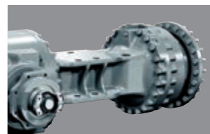
Bloqueo hidráulico del diferencial Para bloquear el diferencial de forma automática (en función del par de transmisión) o manual (opcional en la DL450-3).
