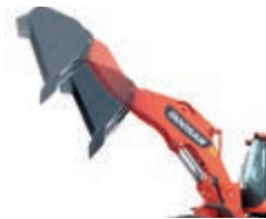
Pluma larga Mejor alcance y altura de descarga en el punto de pivote del cucharón.
