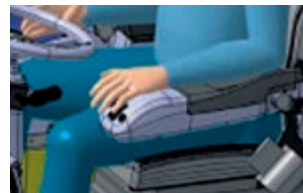
Dirección eléctrica Se encuentra disponible una dirección con joystick para acortar y facilitar los ciclos de carga. 2 modos de dirección: uno para desplazamientos a larga distancia y otro para maniobrar mejor en espacios reducidos. Con esta característica, sigue disponible la dirección convencional.
