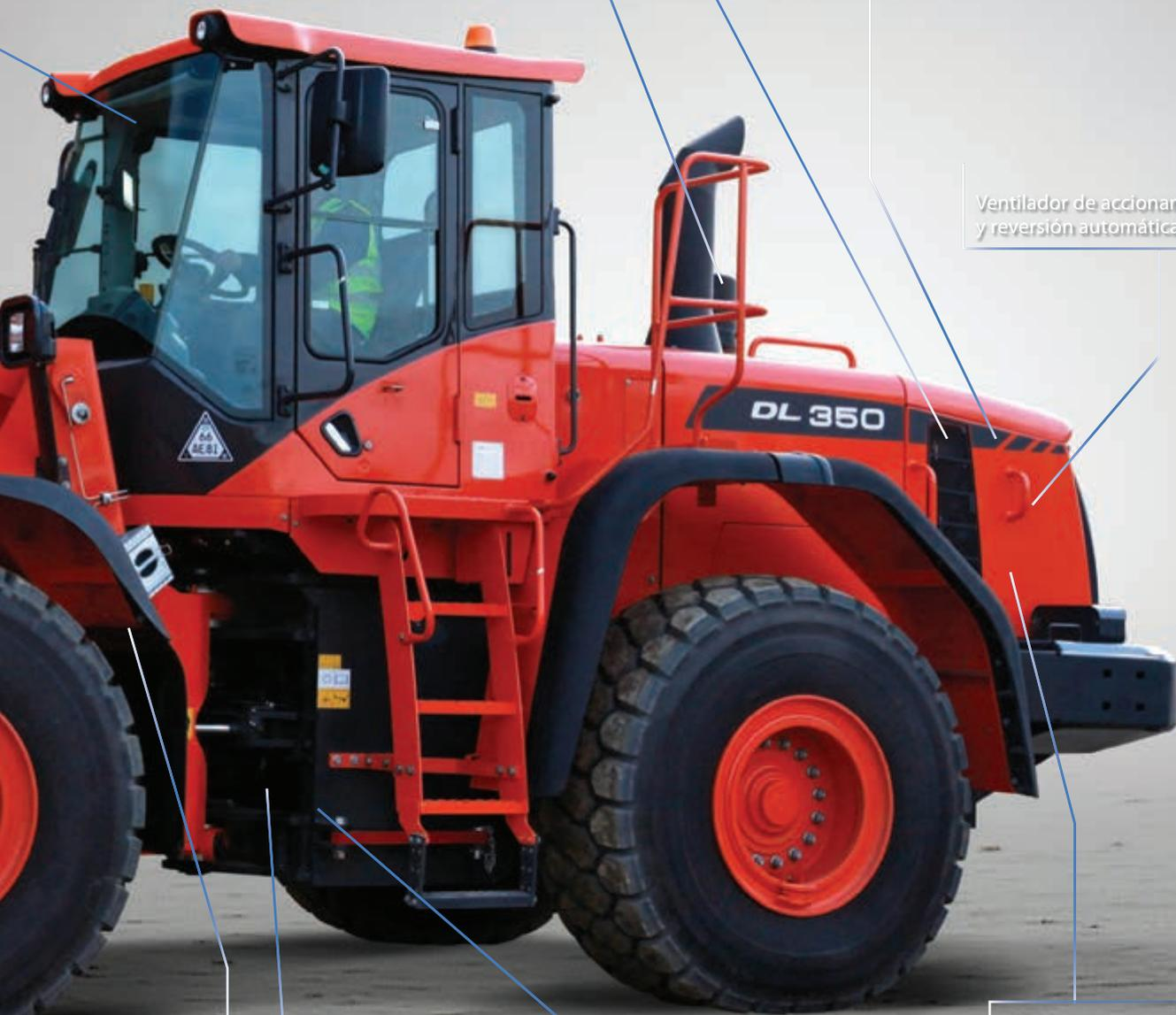
Fácil acceso a los componentes de mantenimiento desde el suelo. Lubricación automática de serie
