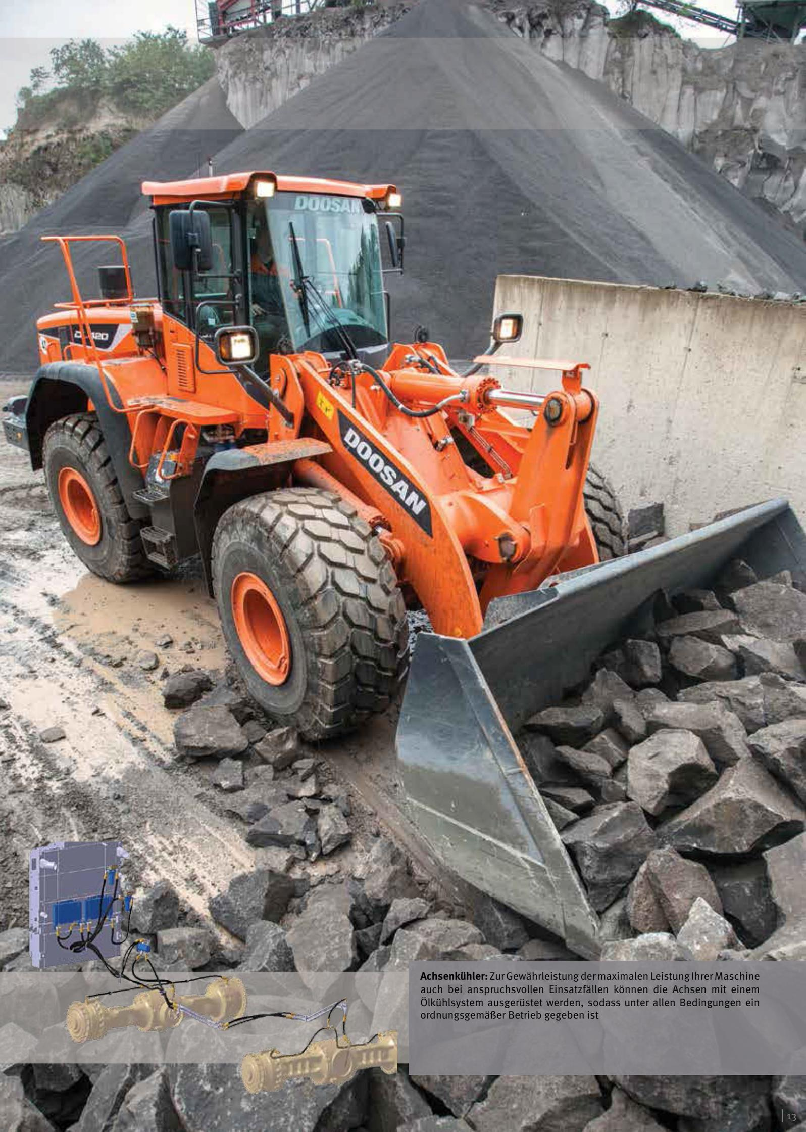
**Achsenkühler:** Zur Gewährleistung der maximalen Leistung Ihrer Maschine auch bei anspruchsvollen Einsatzfällen können die Achsen mit einem Ölkühlsystem ausgerüstet werden, sodass unter allen Bedingungen ein ordnungsgemäßer Betrieb gegeben ist
