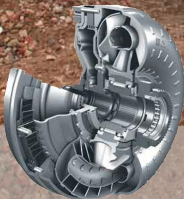
**Sperre:** Der DL420-5 verfügt zudem über eine Drehmomentwandler-Überbrückung. Wird die Funktion aktiviert, wird der Motor bereits ab dem 2. Gang und je nach Geschwindigkeit und Fahrwiderstand automatisch direkt mit dem Getriebe verbunden. Das Getriebe erhält die volle Motorleistung ohne hydraulischen Schlupf - dies sorgt für eine dramatische Steigerung der Geschwindigkeit bei Steigungen.
