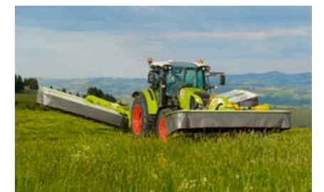
Mediante el enganche compacto en el elevador frontal, la segadora dispone de un gran espacio libre al suelo en los cabeceros.
