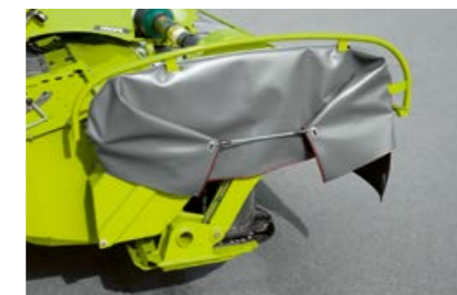
Con el punto de giro colocado bajo, DISCO PROFIL sigue al suelo y no al tractor.
