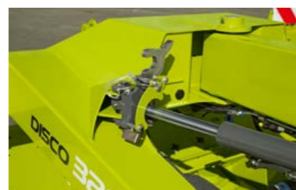
Flexible: Reglaje sin herramientas de la lanza para la rápida adaptación a diferentes tractores (opción)
