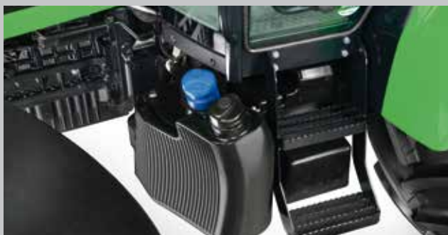
Un serbatoio del carburante che contiene fino a 145 litri e 10 litri di AdBlue consente periodi di lavoro prolungati (in funzione del modello).
