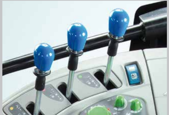
I nuovi comandi dei distributori ausiliari. Precisi, accessibili ed estremamente affidabili per tutte le funzioni operative.
