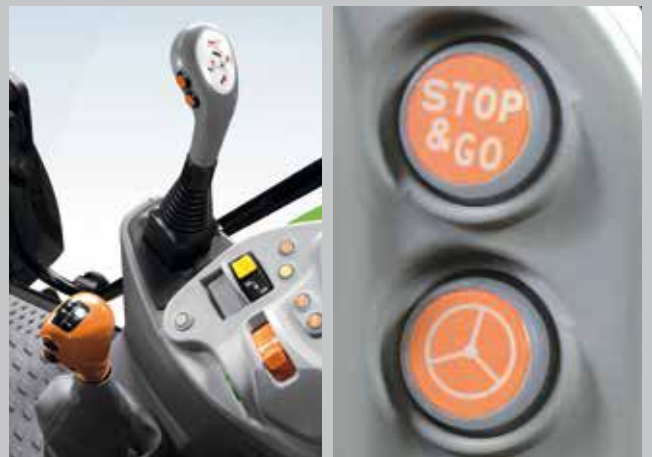
Il joystick del caricatore frontale con i pulsanti Powershift, Stop&Go, sistema di sterzata rapida SDD...
