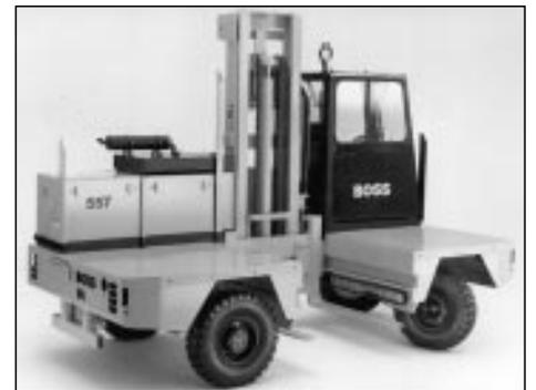
progressive Bremsverzögerung ohne großen Kraftaufwand für sicheres und ermüdungsfreies Fahren. Die Handbremse wirkt mechanisch auf die Antriebsräder. Asbestfreie Bremsbeläge.
