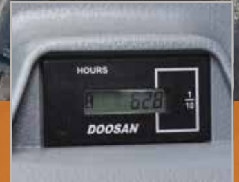
Betriebsstundenzähler (vom Boden aus ablesbar)
