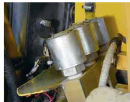
Entlüfterdosen erleichtern die Überprüfung und Reinigung (optional)
