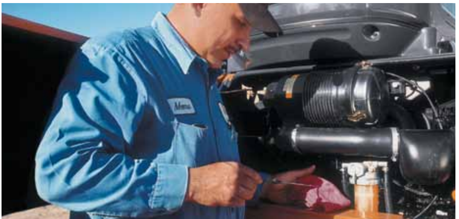
O painel de acesso simples e articulado fornece acesso aos componentes de resfriamento, válvulas e à válvula de mudança do padrão de controle do operador.
