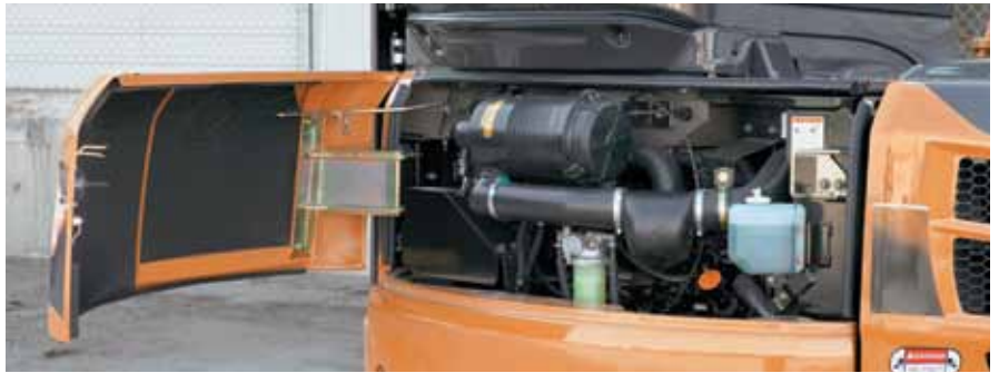
A porta de acesso ao motor permite fácil acesso ao filtro de ar, verificação do nível do óleo e reabastecimento, transbordo de líquido de arrefecimento e ao filtro de combustível.
