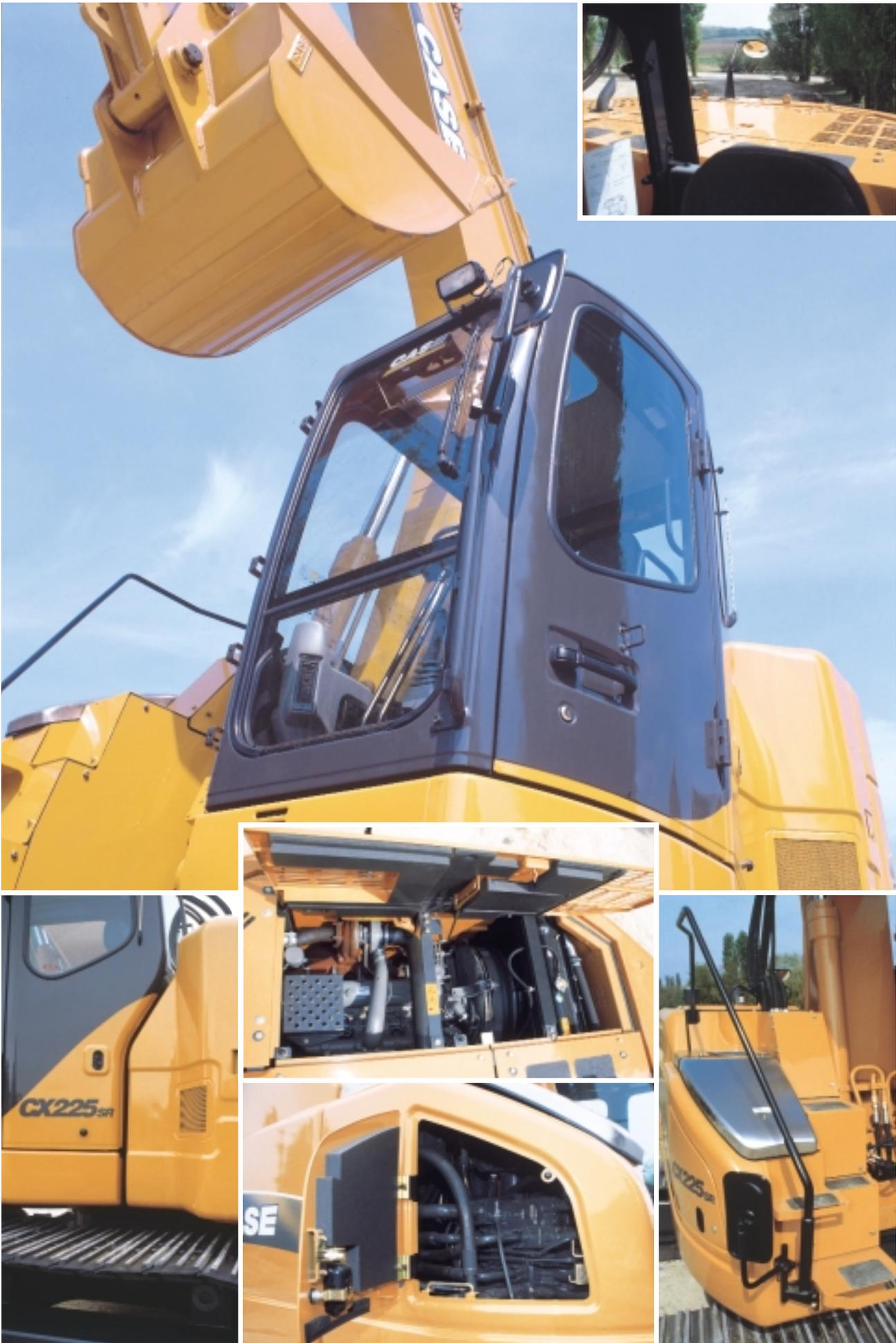
**CX225SR mit Monoblockausleger 5,70 m, Pendelarm 1,90 m, Bodenplatten 600 mm und Löffel mit 1050 l.**
