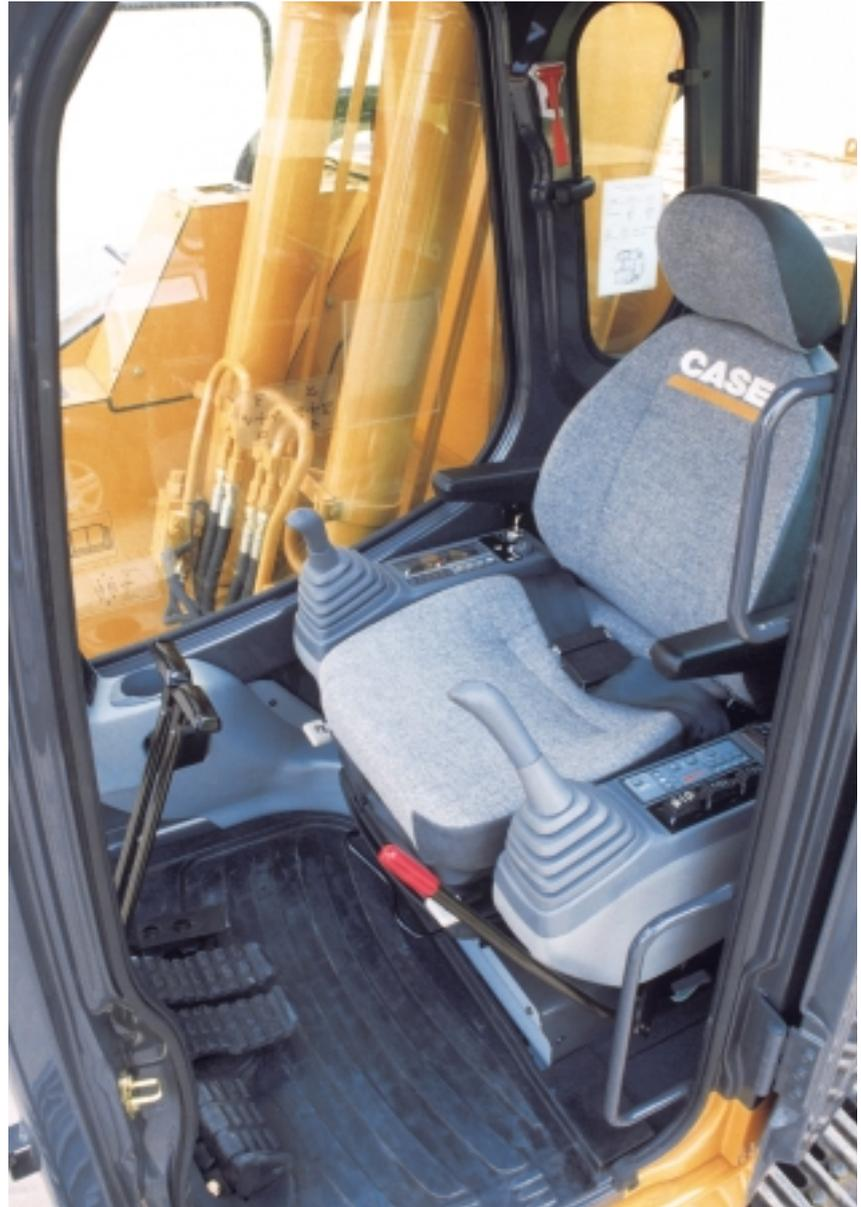
Armaturenbrett und Bedienkonsole rechts und links vom Fahrersitz angeordnet, mit dem Fahrersitz verstellbare Bedieneinheit, zweigeteilte Windschutzscheibe - der obere Teil kann nach oben geklappt werden, der untere Teil ist abnehmbar und kann links hinter dem Sitz sicher verstaut werden.
