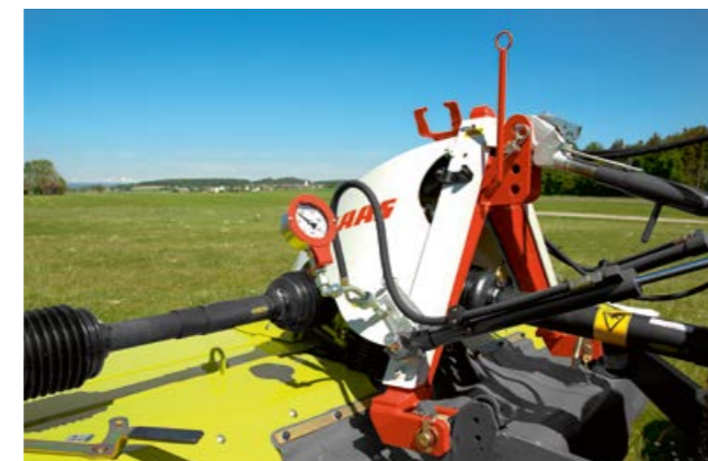
Opcjonalne odciążenie hydrauliczne ACTIVE FLOAT dla kosiarek czołowych.
