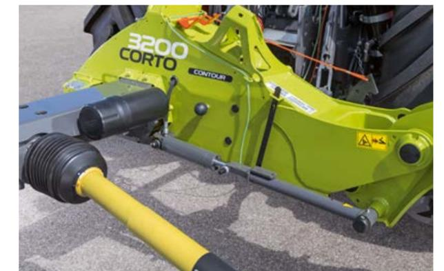
Cilindro ACTIVE FLOAT per l'alleggerimento idraulico del carico della CORTO 3200 CONTOUR.
