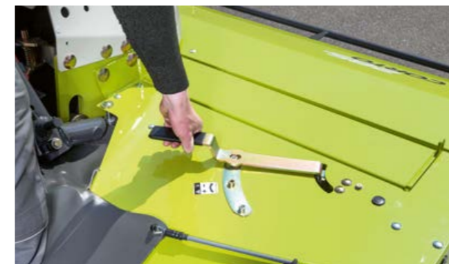
Schwadscheibenverstellung mit einem Handgriff.
