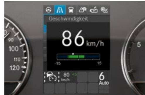
**De cómo optimizar el consumo:** El Predictive Powertrain Control (PPC, opcional) se encarga, junto con el cambio PowerShift, de adaptar la velocidad y los cambios de marcha a fin de lograr una mayor eficiencia, tomando como base la topografía de la ruta que se va a recorrer.
