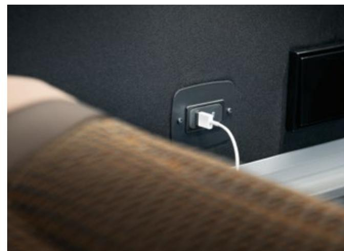
**Nueva energía:** con las conexiones USB opcionales (10,5 W/2,1 A), sus pasajeros pueden cargar cómodamente sus dispositivos electrónicos, tales como teléfonos móviles o cámaras. Elija entre distintas posibilidades de ubicación.
