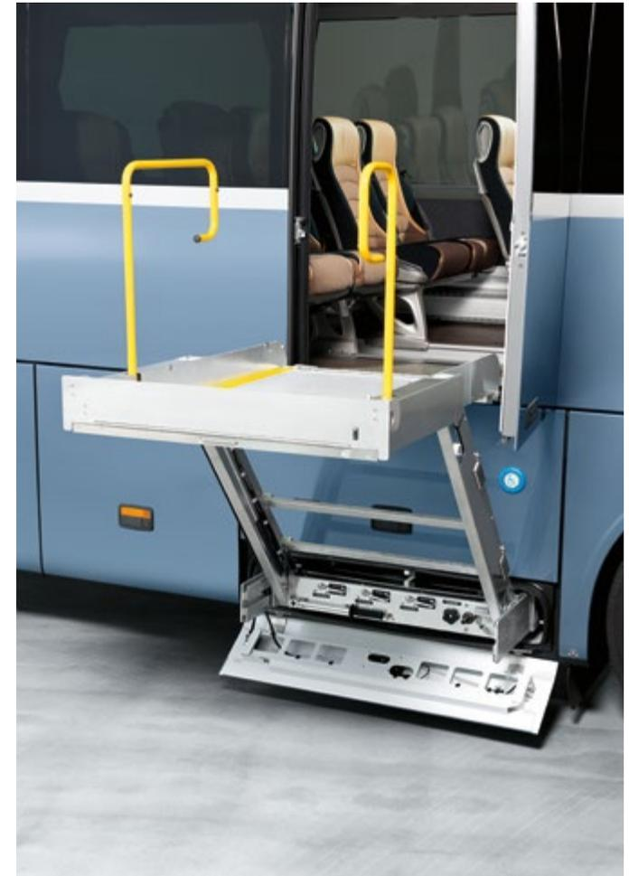
**Transporte sin barreras:** el elevador para silla de ruedas electrohidráulico (opcional) se instala en el maletero detrás del eje delantero y permite la autorización de hasta tres plazas de silla de ruedas.
