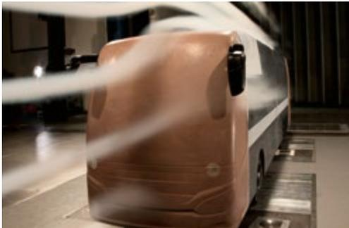
**Diseño aerodinámico:** con su coeficiente CW de 0,33, la ComfortClass marca la pauta en cuanto a resistencia aerodinámica.
