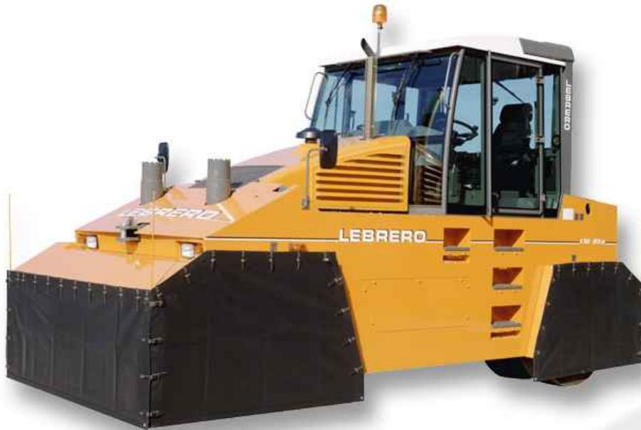
alcanzar un peso total de 23 760 kgs., mediante arena, contrapesos de acero o virutas metálicas en los compartimentos diseñados para tal uso.
