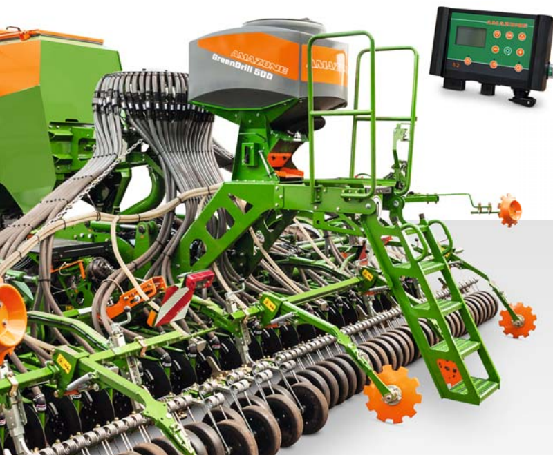
GreenDrill 500 auf Cirrus 6003-2C, für Untersaaten oder Schneckenkorn geeignet
