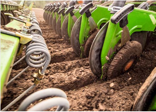
RoTeC pro-Schar mit Rollenstriegel im Einsatz
