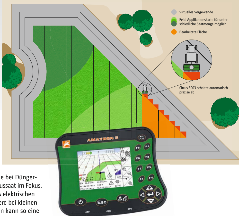
AMATRON 3 mit GPS-Switch bei Cirrus 6003-2
