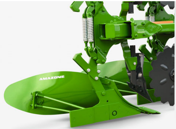
Półautomatyczne zabezpieczenie przed kamieniami
