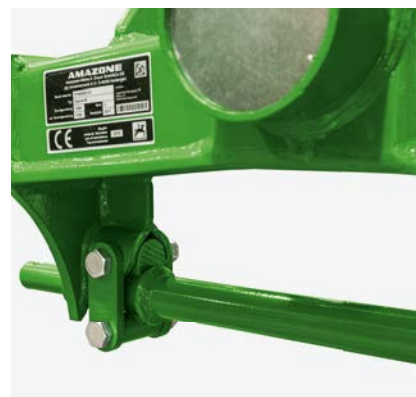
Wentelcilinder met aangesloten zwenkinrichting van het frame.
