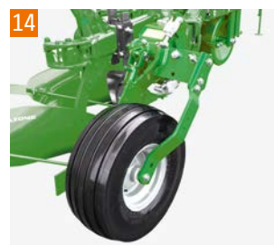
14 Ø kola 680 mm, pneumatika x šířka 250 mm – těžké provedení (se dvěma slupicemi) K dispozici pro: Všechny 6radličné pluhly i 5radličné pluhly řady S a/nebo V
