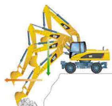
**Погрузка самосвалов.** Повышена производительность и топливная экономичность при погрузке самосвалов с возвышения. Время цикла возврата уменьшено, а при опускании стрелы не потребляется мощность гидронасоса.
