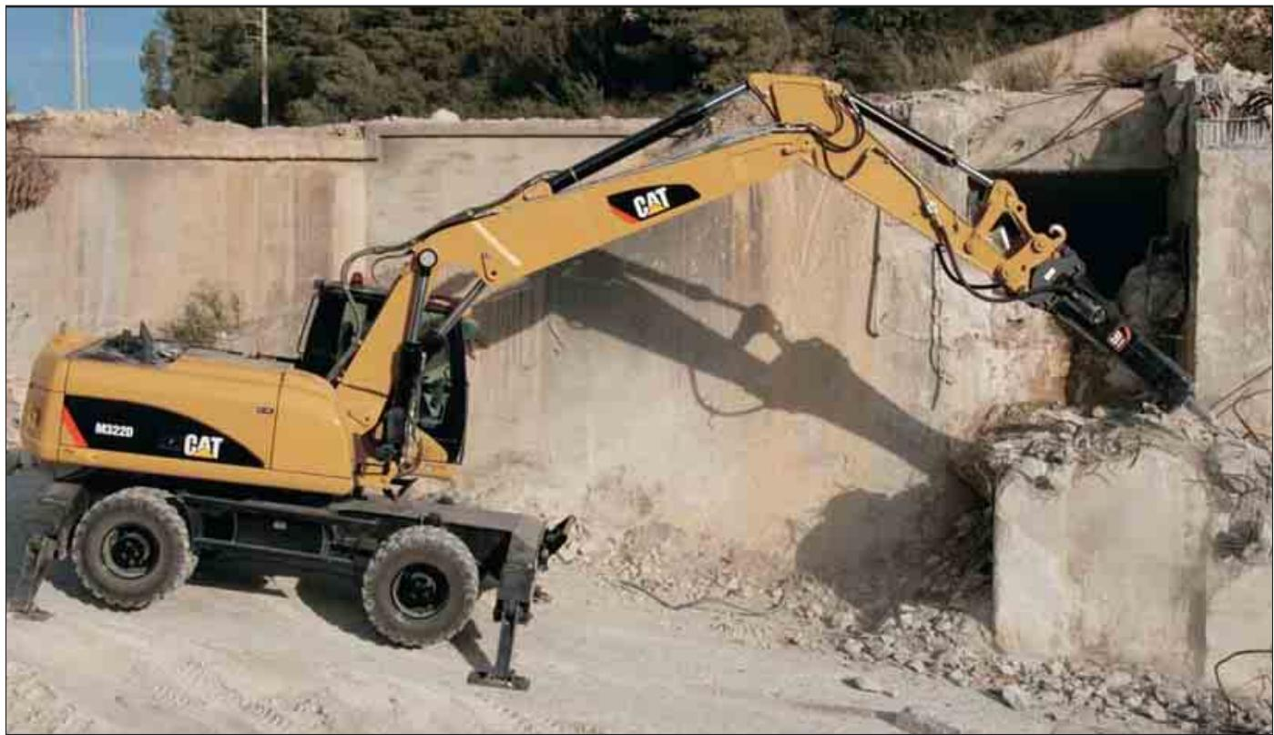
**Конструкция.** Стрелы и рукояти изготовлены из сварных балок коробчатого сечения с толстыми многослойными усиливающими накладками, наваренными в местах наибольших напряжений. Этим обеспечивается высокая прочность и длительный срок службы.
