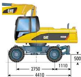
Ходовая часть с двумя парами выносных опор
