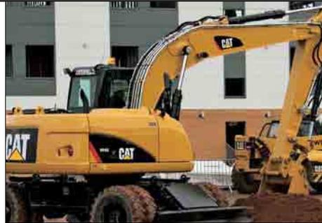
**Двухзвенная стрела.** Благодаря использованию двухзвенной стрелы улучшается обзор с правой стороны машины и распределение веса машины при транспортном движении. Если экскаватор работает в стесненных условиях или используется для поднимания тяжелых грузов, двухзвенная стрела делает машину универсальной.
