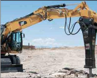
**Конструкция.** Стрелы и рукояти изготовлены из сварных балок коробчатого сечения с толстыми многослойными усиливающими накладками, наваренными в местах наибольших напряжений. Этим обеспечивается высокая прочность и длительный срок службы.
