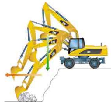
**Погрузка самосвалов.** Повышена производительность и топливная экономичность при погрузке самосвалов с возвышения. Время цикла возврата уменьшено, а при опускании стрелы не потребляется мощность гидронасоса.
