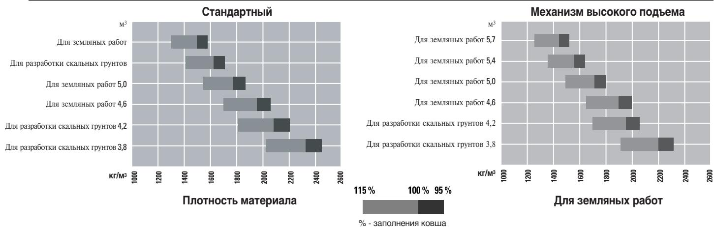
Примечание. В соответствии со стандартом SAE J818 грузоподъемность ковша принимается равной половине опрокидывающей нагрузки при максимальном складывании полурам.
