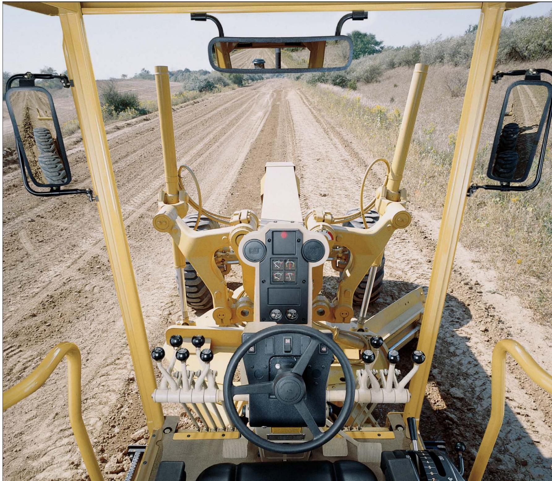
Отличный обзор. Позволяет оператору уверенно чувствовать себя в любых условиях и способствует увеличению производительности грейдера. Рычажная система крепления отвала обеспечивает беспрепятственный обзор: оператору хорошо видны и колеса тандема, и грунт, накапливающийся в отвале. Наклонный капот двигателя делает возможным хороший обзор пространства позади машины.
