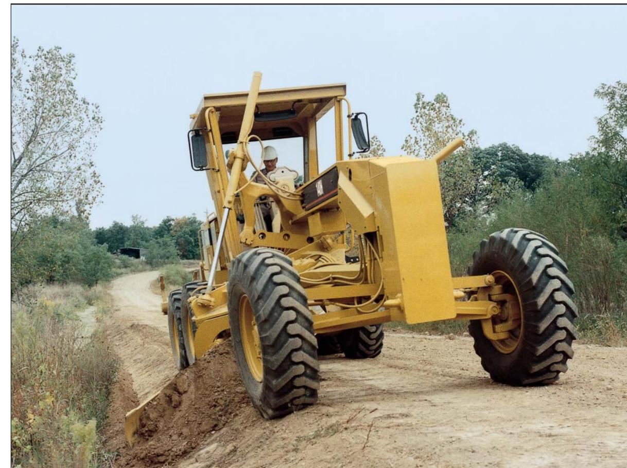
Широкий диапазон положений отвала. Рычажная система крепления отвала расширяет диапазон его рабочих положений. Данная рычажная система наиболее удобна при формировании кюветов и проведении очистных работ.
