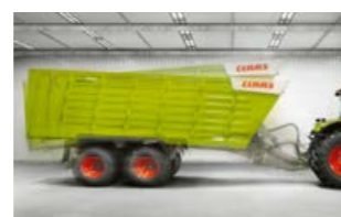
Hydrauliczny, łamany dyszel pozwala maksymalnie podnosić i opuszczać całą przyczepę.
