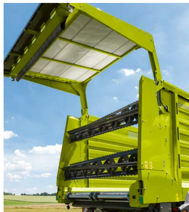
Luk wejściowy umożliwia dostęp do wnętrza skrzyni ładunkowej w celu jej czyszczenia lub konserwacji.
