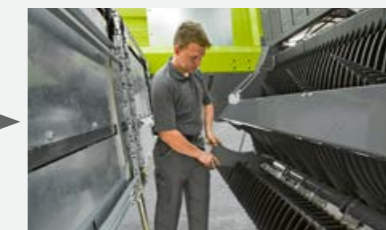
Obrócenie noży, możliwość dalszej pracy z ostrymi nożami.
