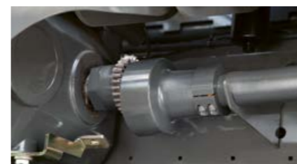
Rozłączyć wałek napędowy.
