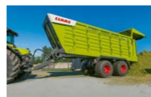
Wyższa prędkość wyładunku z podniesionym, łamanym dyszlem.
