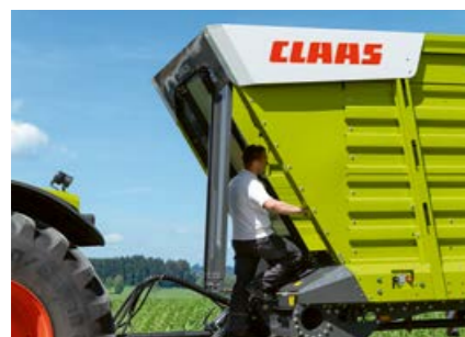
Luk wejściowy umożliwia dostęp do wnętrza skrzyni ładunkowej w celu jej czyszczenia lub konserwacji.
