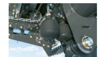
Akumulatory ciśnieniowe dla dostępnej opcjonalnie amortyzacji dyszla.
