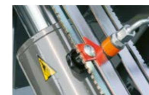
Strzałka znacznikowa poziomej pozycji łamanego dyszla.
