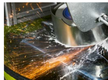
Dzięki stałemu utrzymaniu prawidłowego kąta ostrzenia zachowane są oryginalny promień i kontur noży
