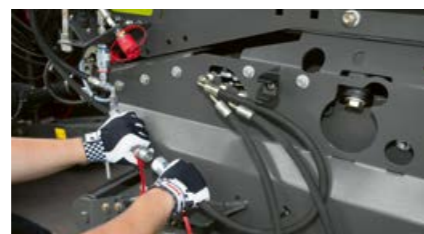
Rozłączyć złącze hydrauliki.
