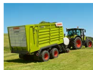
Automatyczna regulacja łamanego dyszla umożliwia łatwe ładowanie w pagórkowatym terenie.
