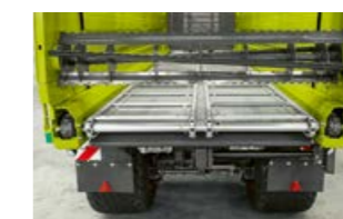
Dwa wydajne silniki hydrauliczne w połączeniu z dwustopniowym napędem gwarantują szybki wyładunek.
