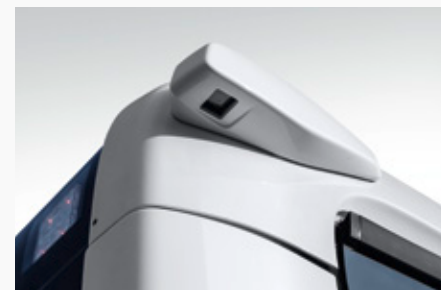
Camera's aan de achterkant Voor controle van achteropkomend verkeer bij de halte en tijdens de rit.
