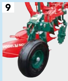
9 Wiel Ø 550 mm, met luchtband x 160 mm breed Verkrijgbaar voor: alle ploegen tot 4-schaar en framehoogte max. 78 cm
