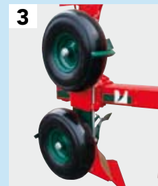
3 Wiel Ø 550 mm, met luchtband x 160 mm breed Verkrijgbaar voor: M, XM en XMS ploegen. Alle framehoogten.
