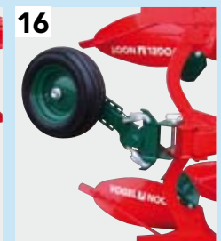
Zwenkadapter Zwenkadapter waarmee het wiel kan worden weg geklapt bij het grensploegen.
