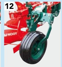
12 Wiel Ø 600 mm, met luchtband x 220 mm breed – zware uitvoering (dubbele steel) Verkrijgbaar voor: alle 6-schaar en 5-schaar ST en/of Vario ploegen)
