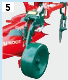
5 Wiel Ø 500 mm, staal x 185 mm breed Verkrijgbaar voor: alle ploegen tot 4-schaar en framehoogte max. 78 cm
