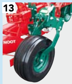
13 Wiel Ø 680 mm, met luchtband x 250 mm breed – zware uitvoering (dubbele steel) Verkrijgbaar voor: alle 6-schaar en 5-schaar ST en/of Vario ploegen)
