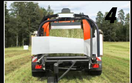
Podczas prasowania kolejnej bali owijarka rozpoczyna owijanie drugiego balotu dwoma rolkami folii.
