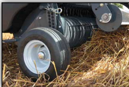
Wysokość robocza podbieracza regulowana, jest na kołach podporowych.
