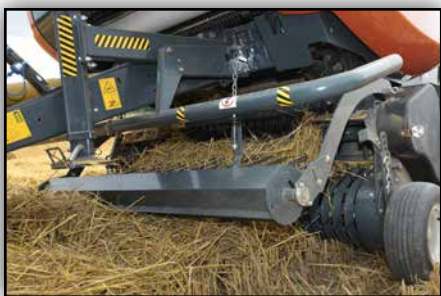
Rolka dociskowa do krótkiego materiału umożliwia równomierne podbieranie pokosu oraz dużą wydajność.
