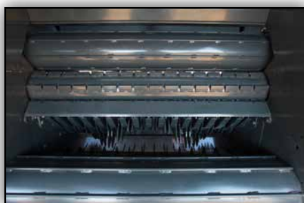
W prasach Kubota serii BF2255 przednia część komory posiada walce...
