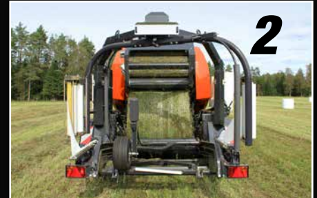
Owinięta siatką bala zrzucana jest bezpośrednio na stół owijarki.
