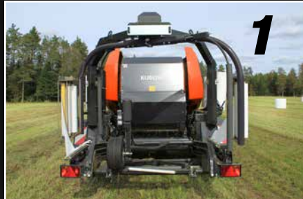
Podczas owijania siatką stół owijarki przesuwany jest w kierunku prasy.
