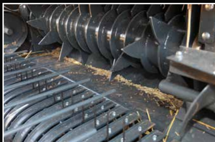
Rotor PowerFeed bez noży tnących.
