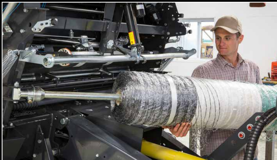
Nisko umieszczony aparat do owijania ułatwia rolnikowi wymianę dużych i ciężkich rolek siatki.
