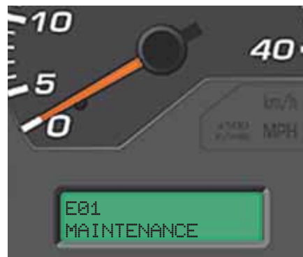
Układ monitorujący EMMS (Equipment Management and Monitoring System)
