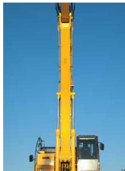
Ściany wysięgnika z jednego kawałka blachy
