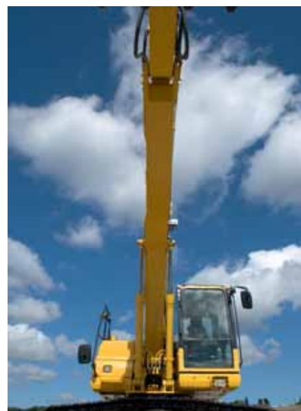
Ściany wysięgnika z jednego kawałka blachy
