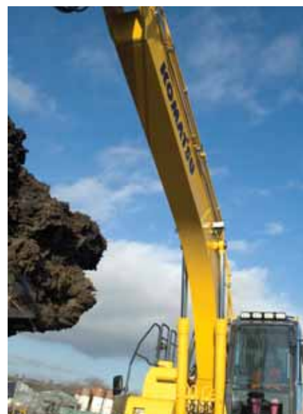
Ściany wyciągnika z jednego kawałka blachy
