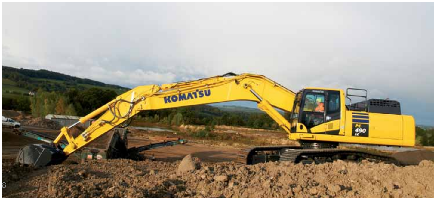
Gravespaker med brytere for proporsjonalstyring av redskaper
