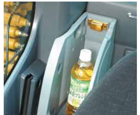
Geïsoleerde opbergruimte voor warme of koude levensmiddelen
